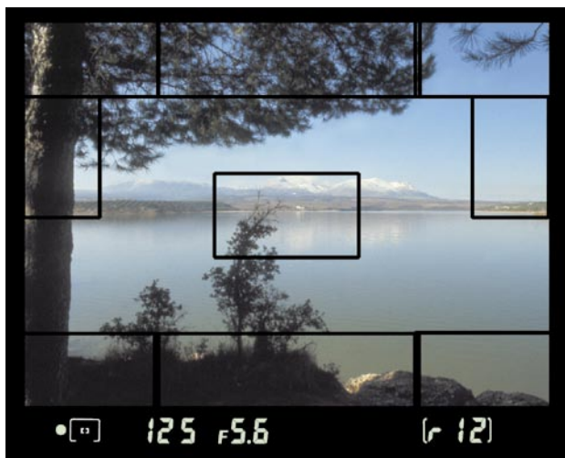
Рис. 3.11. Точечное измерение позволяет определить экспозицию на основе освещенности ограниченной области кадра
