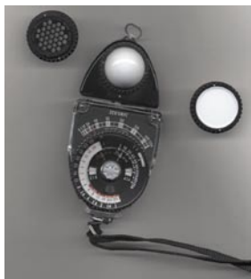
Рис. 5.15. Ручной фотометр может быть удобен при съемке спортивных событий, когда необходимо выбрать правильную экспозицию
