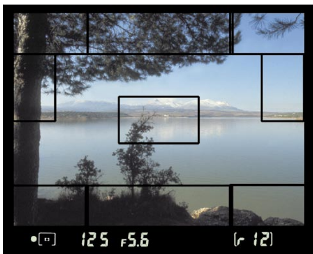
Рис. 3.10. При использовании матричного измерения делается предположение о типе фотографии. Для этого оценивается освещенность отдельных зон сцены
