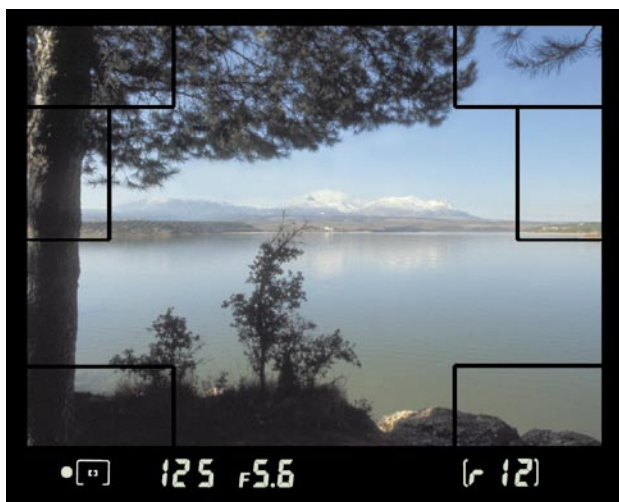
Рис. 3.8. В режиме граничного измерения при вычислении экспозиции больший вес имеет освещенность по краям кадра
