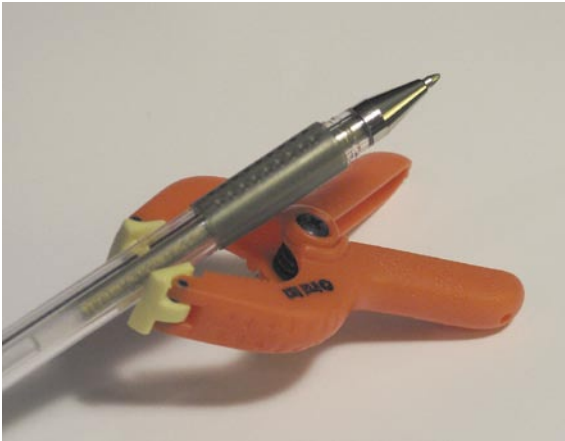
Рис. 10.19. Этот недорогой зажим можно использовать, чтобы сохранить неподвижность объекта при установке фокуса
