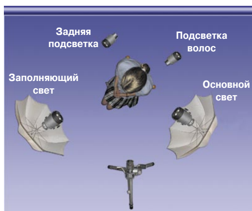
Рис. 6.21. Диаграмма расположения источников света для реализации широкоугольного освещения. При необходимости можно воспользоваться также и зеркальным отражением этой диаграммы
