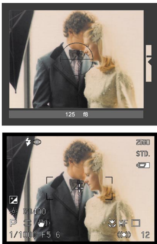
Рис. 2.22. Ранее в окошке видоискателя отображались только скорость срабатывания затвора, f -число и выдержка (вверху). Цифровые камеры обеспечивают гораздо больше информации (внизу)!
