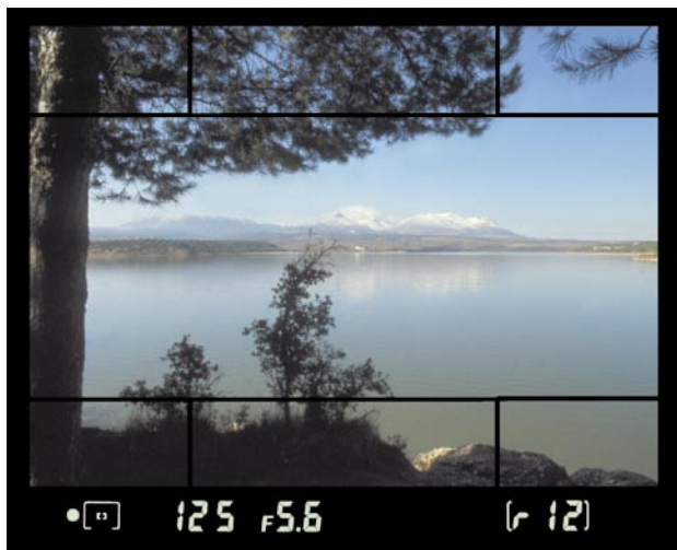
Рис. 3.9. Режим верхнего или нижнего взвешенного измерения позволит учесть освещенность верхней и нижней части кадра
