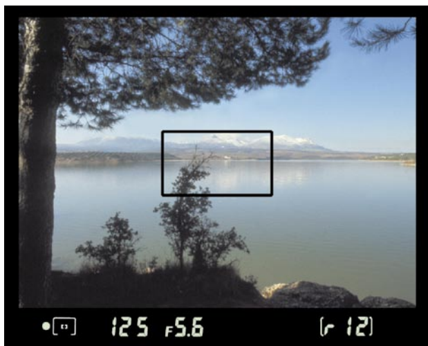
Рис. 3.7. При использовании режима центровзвешенного измерения экспозиция будет вычисляться на основе освещенности центральной части сцены
