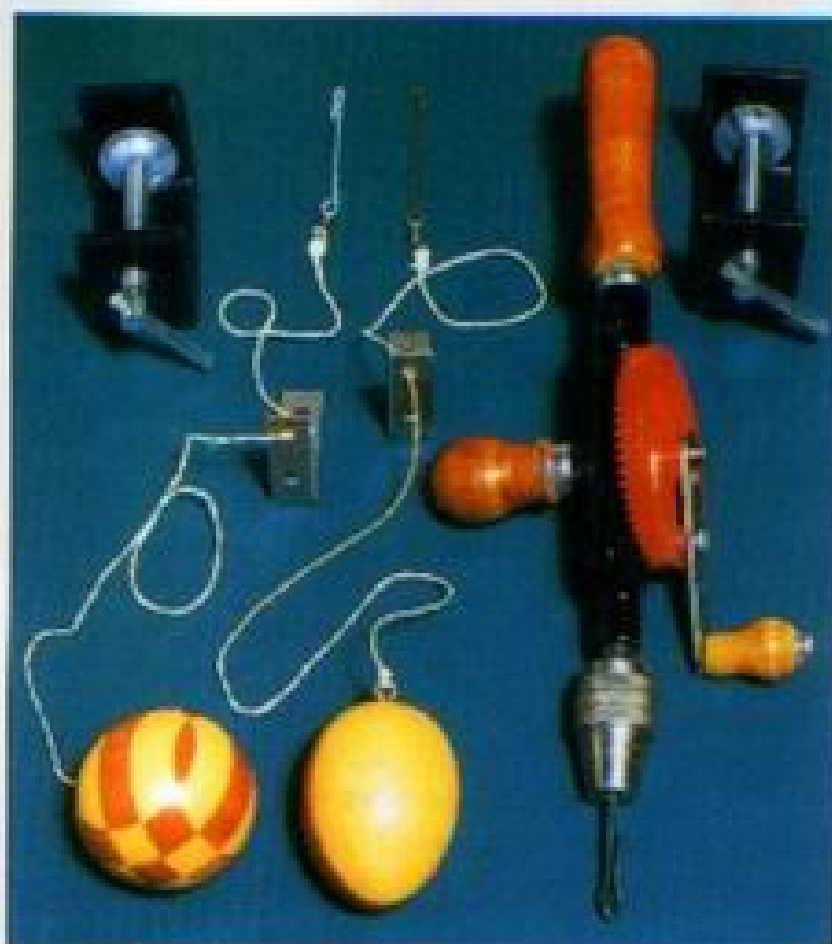
Оборудование для скручивания косичек: ручная дрель, тиски, уголки, бечевка, груз, проволочные крючки.
