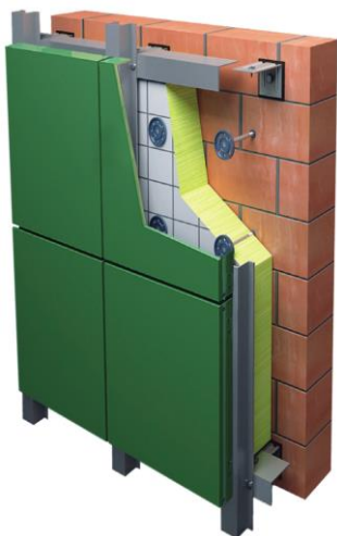
Принцип кріплення панелей композитного матеріалу
