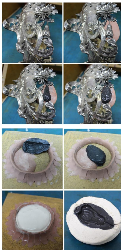
Рис. 2. Процес зняття форми для дублювання втраченого елемента та процес формування гіпсового кожуху для силіконової форми.
