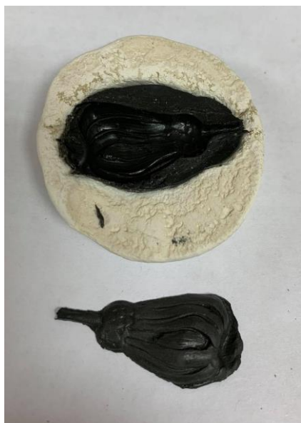
Рис. 3. Здубльований втрачений елемент зазначеною мастикою. Виконавець реконструкції – Мостовий С.В.
