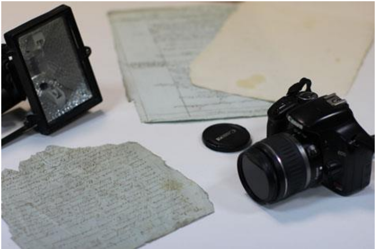
Іл. 50. Модифікований для зйомки в інфрачервоному спектрі цифровий дзеркальний фотоапарат Canon XSi з роздільною здатністю 12 мегапікселів. Фотоапарат обладнаний фільтром «Pro-HD IR1K», який дозволяє проводити зйомку при довжині хвилі 1000 нм
