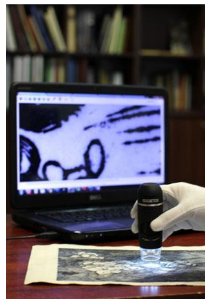
Іл. 25. Цифровий мікроскоп SigetaExpert з можливістю збільшення зображення \times 50 і \times 250 та дослідження графіки (праворуч)
