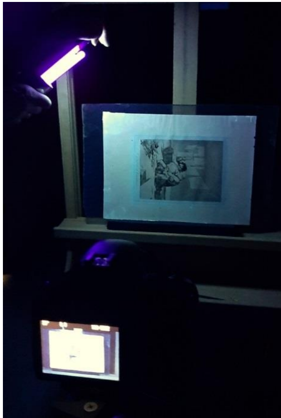
Іл. 38. Мініатюрна потужна УФ-лампа з рефлектором (область променів Вуда, діапазон 315–400 нм з максимумом при 360 нм)
