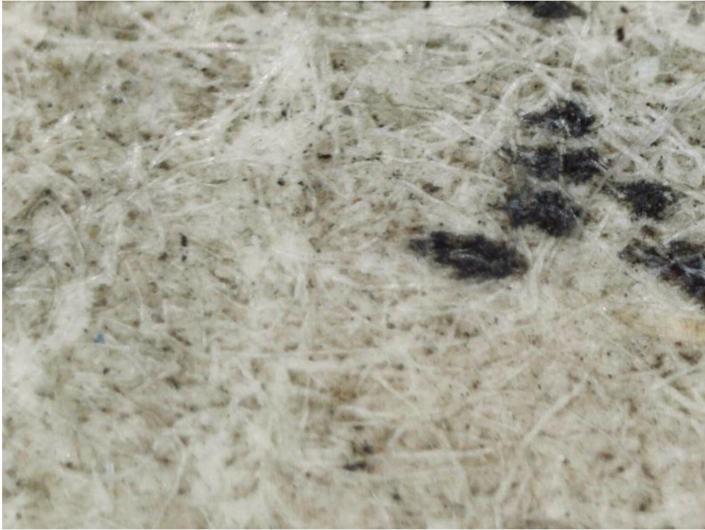
Іл. 30. Мікрофотографія паперу гравюри А. Дюрера з целюлози рослинного походження (льон) з ганчір'я (збільшення x250)
