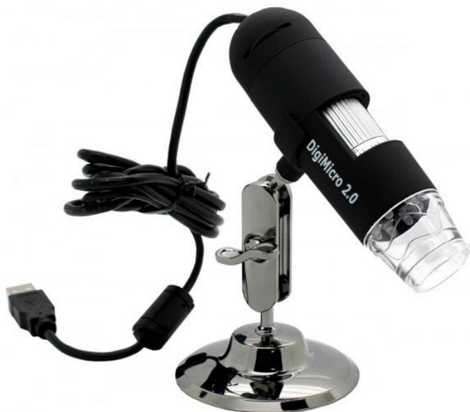
Іл. 25. Цифровий мікроскоп SigetaExpert з можливістю збільшення зображення \times 50 і \times 250 та дослідження графіки (праворуч)
