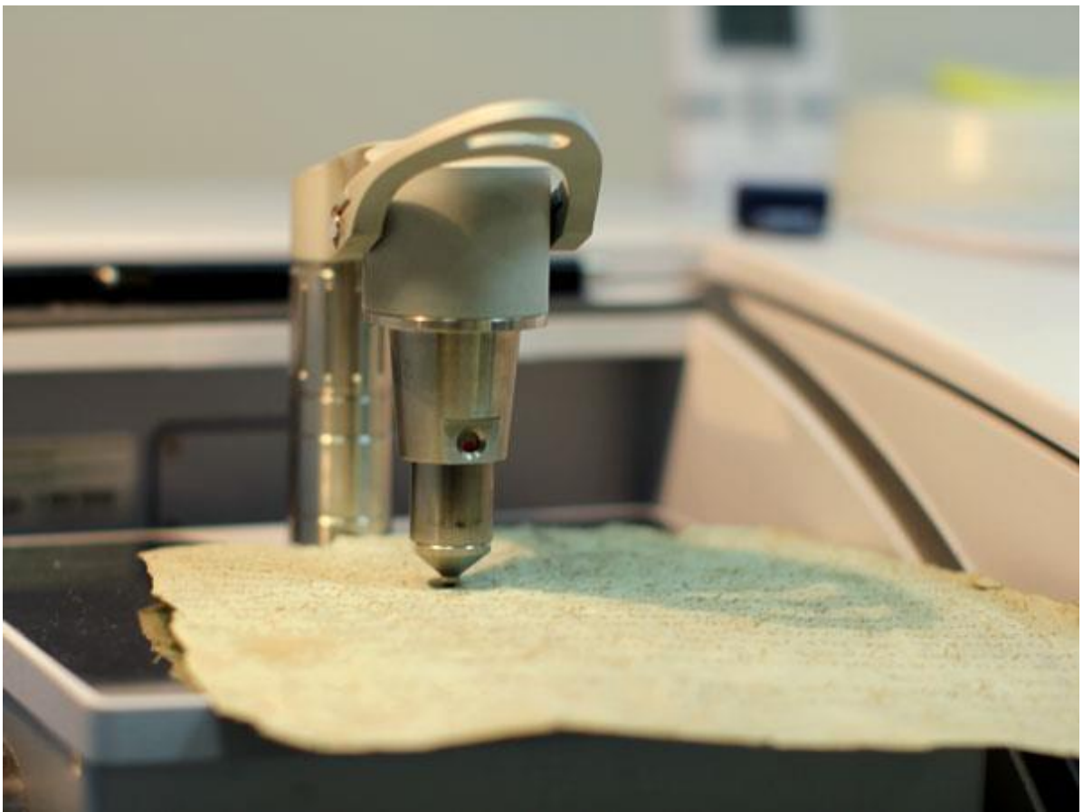
Іл. 53. Інфрачервоний спектрометр. Модель Vertex 70 компанії Bruker Optics (Німеччина) із приставкою Platinum ATR Bruker
