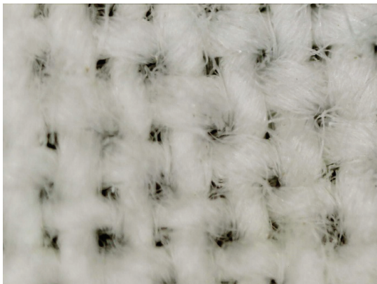
Іл. 10. Макрофотографія полотна з бавовняного волокна (збільшення x250)
