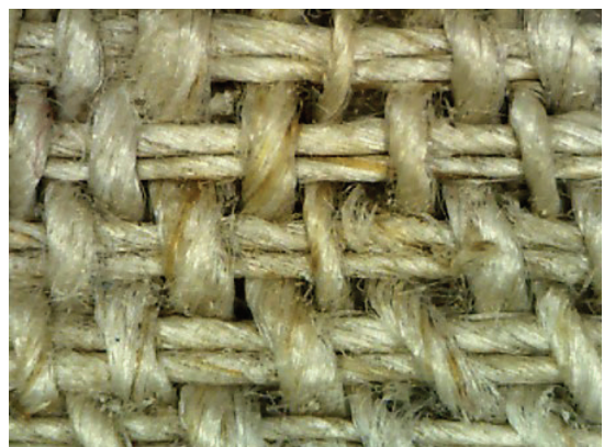
Іл. 13. Макрофотографія полотна складного прямого переплетення (репс) (збільшення x50)
