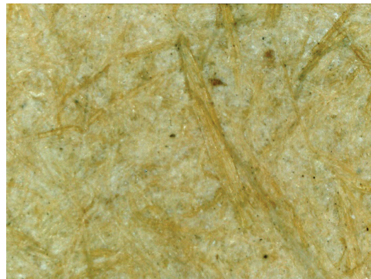
Іл. 38. Макрофотографія рослинних волокон і волокон деревної целюлози у складі паперу (збільшення x250)
