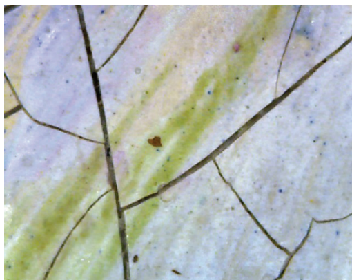
Іл. 28. Макрофотографія кракелюра, обумовленого старінням в'язива (збільшення x50)
