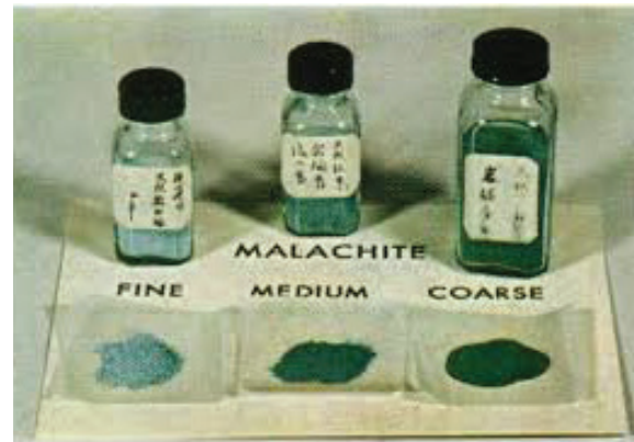
Іл. 35. Подрібнений природний малахіт. Різний ступінь помелу призводить до зміни яскравості пігменту. Джерело ілюстрації: Gettens, R. J., Fitzhugh, E. W., 1974
