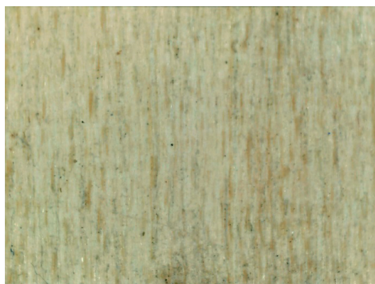
Іл. 7. Макрофотографія деревини бука (збільшення x50), поперечний розпил (ліворуч) та тангенційний розпил (праворуч)
