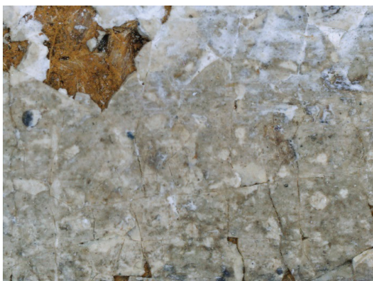
Іл. 24. Макрофотографія ґрунту фабричного двошарового (збільшення x50), картина XIX ст
