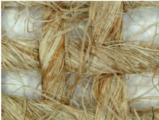
Іл. 8. Макрофотографія полотна з коноп'яного волокна (збільшення x50)
