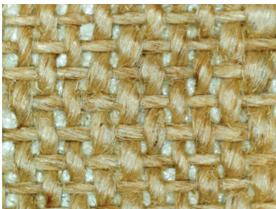
Іл. 12. Макрофотографія полотна простого прямого переплетення (збільшення x50)
