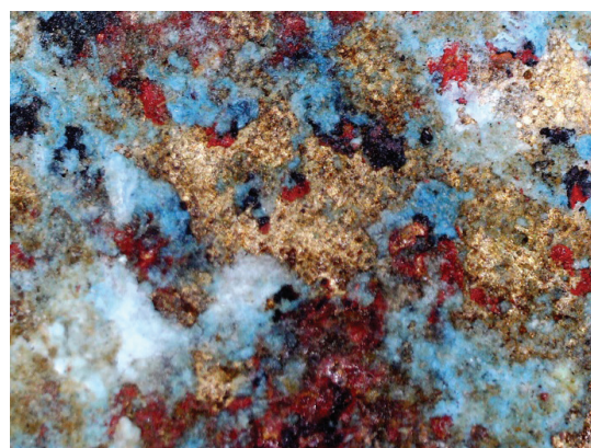
Іл. 42. Макрофотографія штучної патини на поверхні виробу з бронзи (збільшення x50)
