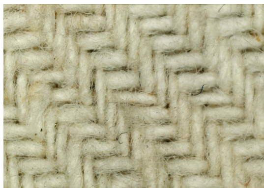
Іл. 15. Макрофотографія полотна діагонального (саржевого) переплетення (збільшення x50)
