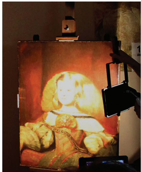
Іл. 53. Огляд твору живопису в ІЧ-діапазоні при наявності джерела інфрачервоного випромінювання
