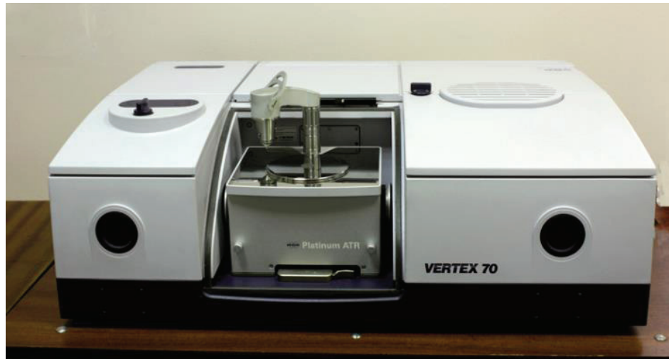
Іл. 4. Спектрометр фірми Bruker Vertex 70 (Німеччина) з приставкою Platinum ATR з елементом порушеного повного внутрішнього відбиття (алмазне вікно). Діапазон вимірювання довжин хвиль 400\text{--}4500\text{ см}^{-1} з точністю 0,5\text{ см}^{-1}
