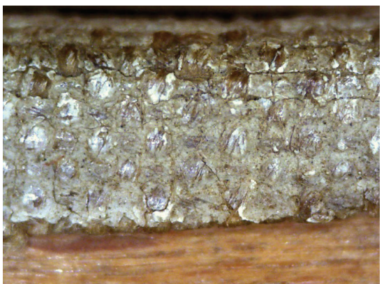
Іл. 25. Макрофотографія ґрунту фабричного одношарового (збільшення x50), картина XIX ст.
