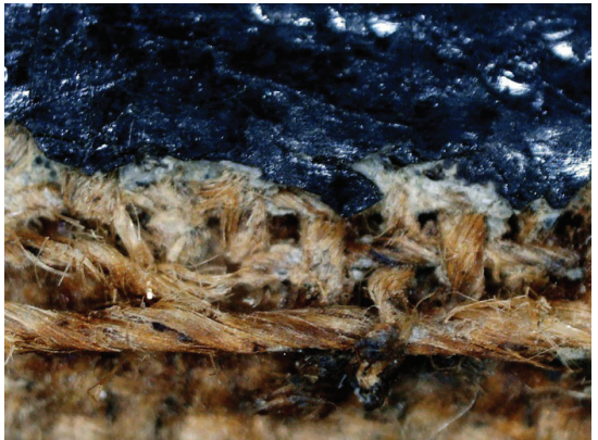
Іл. 23. Макрофотографія ґрунту одношарового (збільшення x50), картина XVIII ст.
