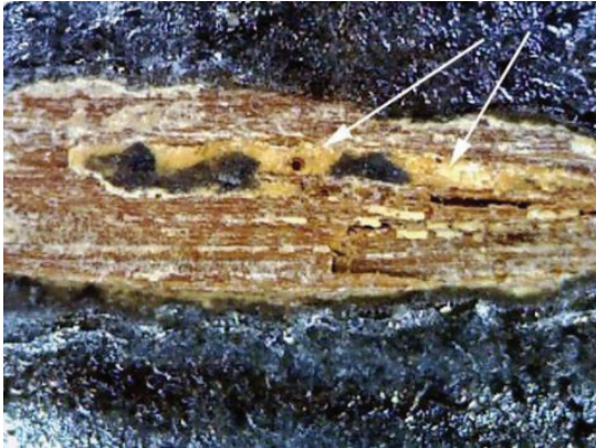
Іл. 20. Макрофотографія ґрунту на дерев'яній основі (збільшення x50), картина XVII ст.
