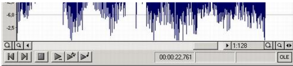
Рис. 11.5. Вставка дополнительных звуковых данных в видеофайл приводит к появлению в его конце пустых кадров
