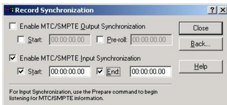
Рис. 6.11. Диалоговое окно Record Synchronization для установки параметров синхронизации
