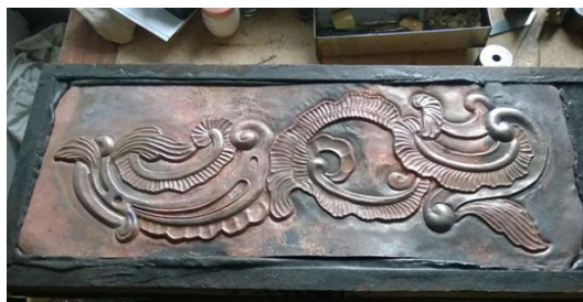
Рис. 3. Процес утворення оксидної плівки під час карбування в міді
