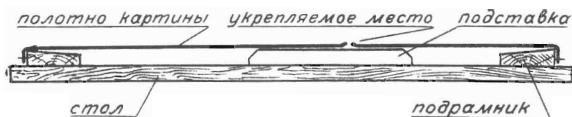
II. Схематическое изображение укрепляемой картины без снятия с подрамника (в разрезе)
