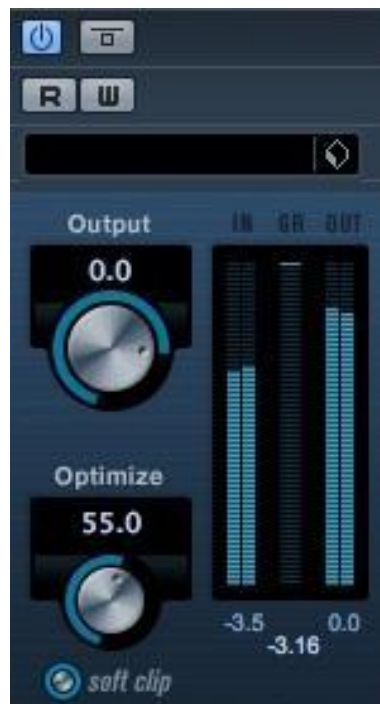
Мал.19.1 «Приклад комбінованого модуля перед-підсилювача та лімітера – Maximizer»
