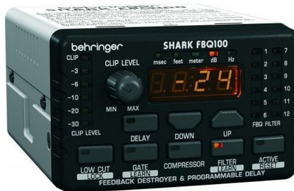
Мал.26 «Один з спеціалізованих приладів пригнічення зворотного зв'язку»
