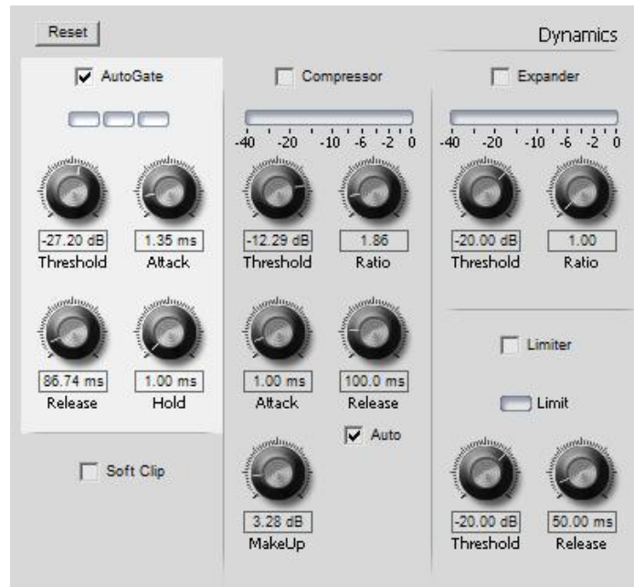
Мал.19.2 «Приклад комбінованого модуля перед-підсилювача, компресора, розтягувача та лімітера – Dynamics»
