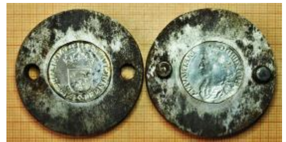
Рис 2.2.2. Приклад форми для підробки монети методом виготовлення двох суміщених штемпелів
