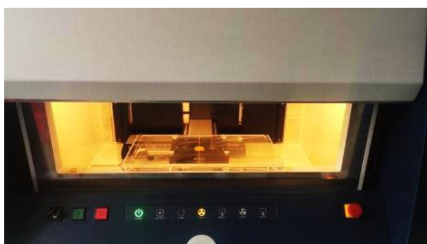
Ілюстрації 4-5. Монета під час дослідження безконтактним методом рентгенофлуоресцентному аналізатором (РФА) «M4 Tornado BRUKER»
