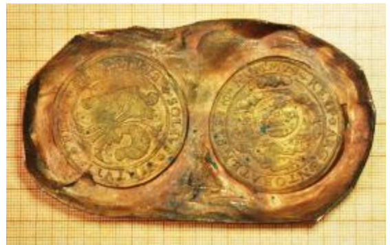
Рис. 2.2.1. Приклад форми для підробки монети виготовлена на мідній пластині, методом карбування, у якості ливарної форми
