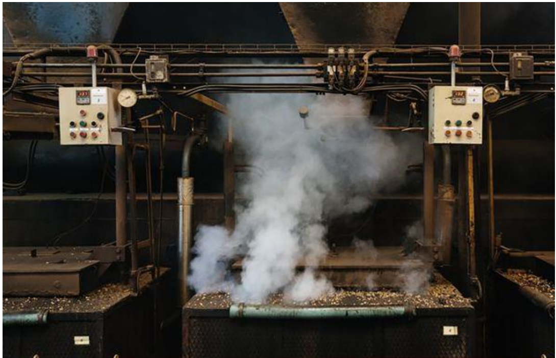
Рис. 2.12. Обробка паром роздріблений корк.
