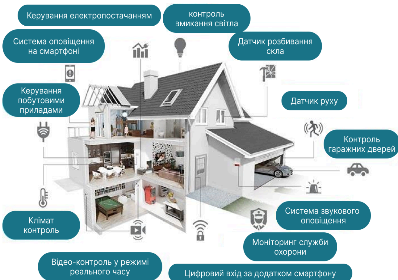
Рис. 2.4. Взаємодія елементів системи «розумний дім» з можливістю керування ними через смартфон [60]
